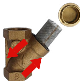
Sfilare l'elemento filtrante e inserire l'elemento filtrante pulito o nuovo
